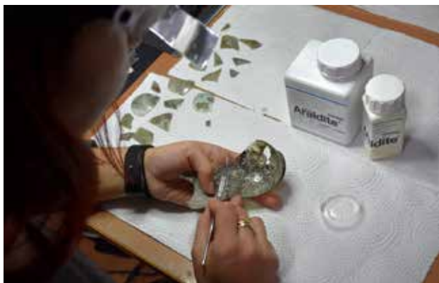
Слика 17. Нанесување на епоксидната смола Araldite 2020 врз споевите од фрагментите.
